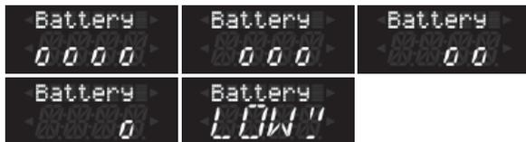
“Battery 0000” – максимальный заряд, “Battery 000” – высокий, “Battery 00” – средний и “Battery 0” – низкий.
